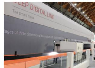
萨克米展示的无水数码施釉线包含了三台机器，分别用于数码喷釉、喷墨打印和胶水干粒一体装饰。
