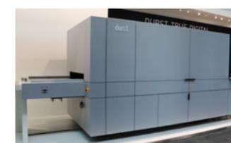
得世今年终于成功推出了可用于量产的水性数码釉线。该釉线前面配备了一台两通道的 Gamma DG 喷釉机，可以实现打印 45 微米的水性釉料，最多可实现 1kg/m<sup>2</sup> 的打印量。同时它可以在两个通道实现不同的喷釉效果，例如在同一片砖面上实现亮光和哑光的结合。
